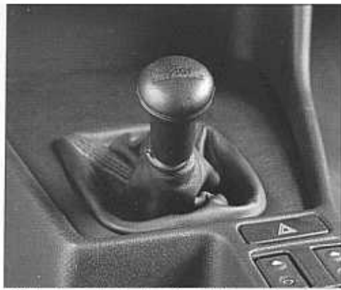
AC Schnitzer Lederschaltknopf zur Verkürzung der Schaltwege.
