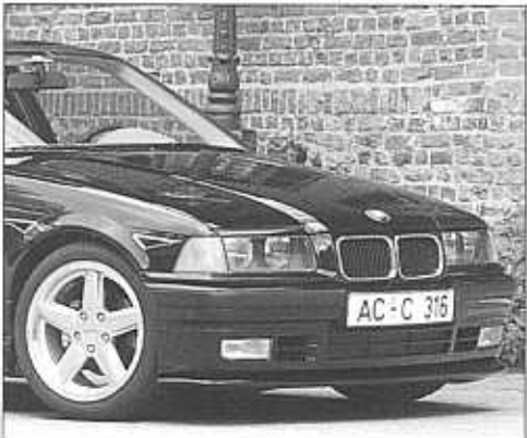
AC Schnitzer Frontspoiler Typ I aus PUR Rim zur Erhöhung des Abtriebs an der Vorderachse.
