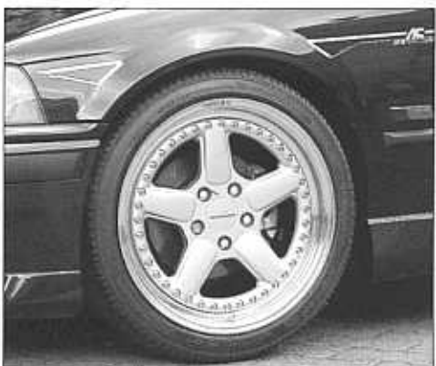
AC Schnitzer Rennsportfelge 8,5J x 18" Vorder- und Hinterachse oder 9,0J x 18" Hinterachse.
