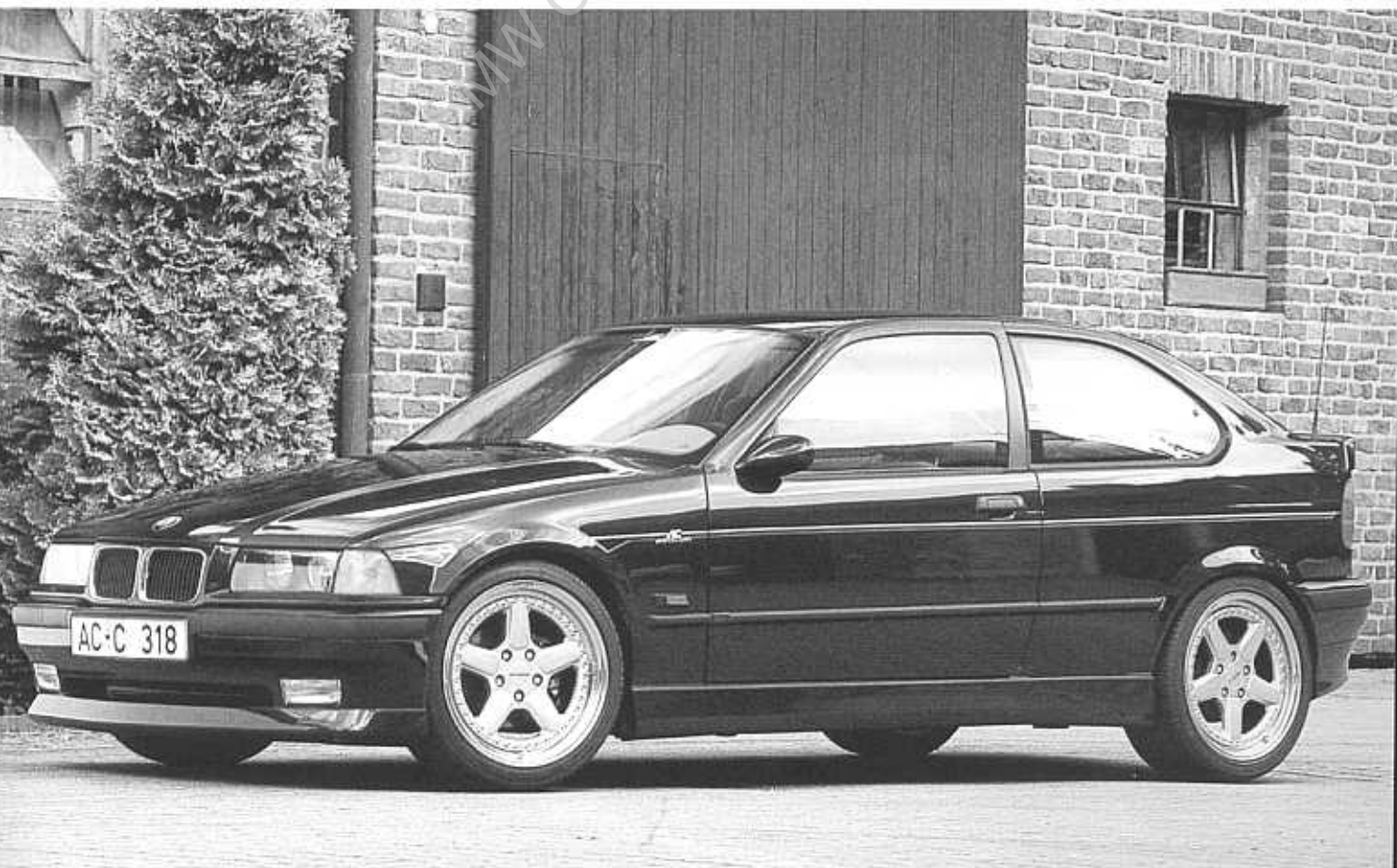
Frontspoiler und Seitenschweller Typ II, Sportspiegel und Rennsportfelgen 8.5J x 18" an der Vorderachse und 9.0J x 18" an der Hinterachse.
