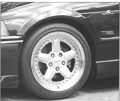
AC Schnitzer Rennsportfelge 8,0J x 17" Vorder- und Hinterachse oder 9,0J x 17" Hinterachse.
