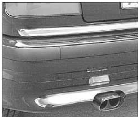
AC Schnitzer Auspuffendblende Edelstahl verchromt. Auch Bestandteil des AC Schnitzer Sportnachschalldämpfers (Mehrleistung ca. 4 - 6 PS).
